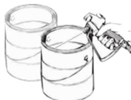
4. Когда промывочная жидкость начнет поступать из краскораспылителя, продолжайте нажимать спусковой механизм и направьте краскораспылитель на стенку ненужного контейнера (**заземлите краскораспылитель металлическим контейнером при промывке легко воспламеняющимся растворителем**).
