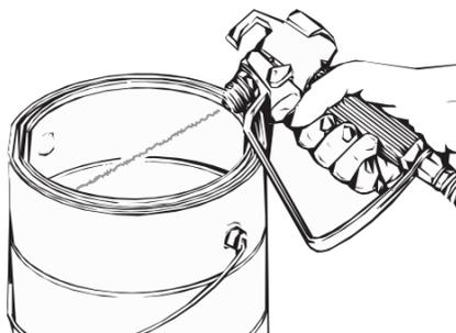
4. Отпустите спусковой механизм. Поверните ручку PRIME/SPRAY, в положение PRIME. Выключите насос, переведя переключатель в положение (O). Направьте краскораспылитель в ненужный контейнер и нажмите на спусковой механизм, чтобы убедиться, что в шланге не осталось давление.
