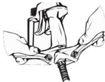
3. Снимите фильтр из краскораспылителя (см. раздел по **Очистке фильтра краскораспылителя**)
