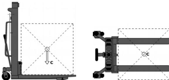
При работе с грузом не устанавливайте груз на концы вил, не перевозите неустойчивый или плохо размещененный груз во избежание его падения. Будьте осторожны и внимательны при подъёме и опускании груза. При движении с грузом вилы следует опустить как можно ниже. При работе со штабелером никогда не стойте под вилами и не вставайте на них во избежание травм.
